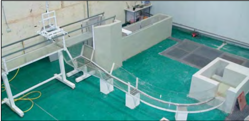
Figura 1. Infraestructura para el estudio de sistemas de captación de fondo de la Universidad Politécnica de Cartagena.
